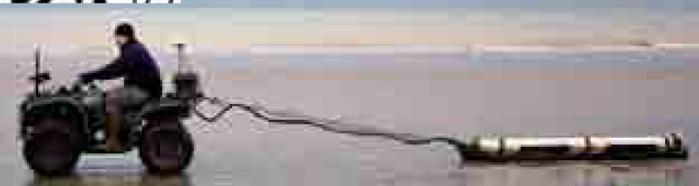
Een DUALEM-21S bodemsensor voortgetrokken door een quad op het strand (BE). © K. Vandevorst/Onroerend Erfgoed/A2S
