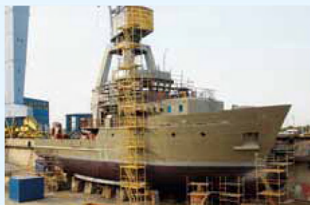
september 2011: volledig geassembleerd in droogdok in Roemenië
