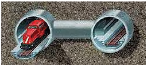
figuur 3.15 Dwarsverbinding Botlekspoortunnel
