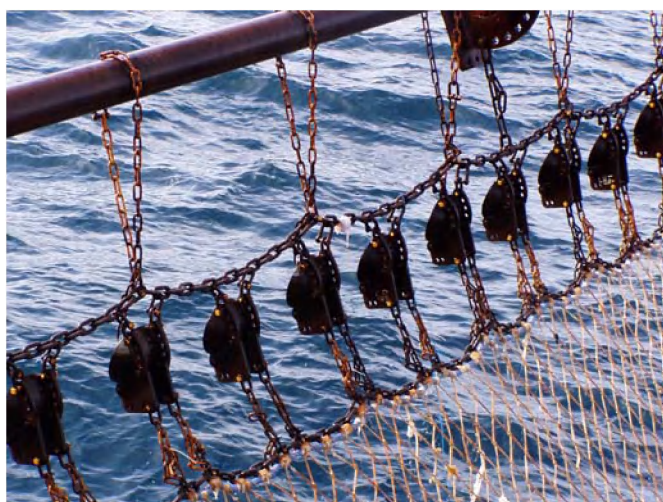
Figuur 3-15: Vijfde ontwerp HydroRig met zwaardere wangen (detail rechts) getest eind mei 2010 (Bron: K.J. Koffeman, schipper FD-281)
