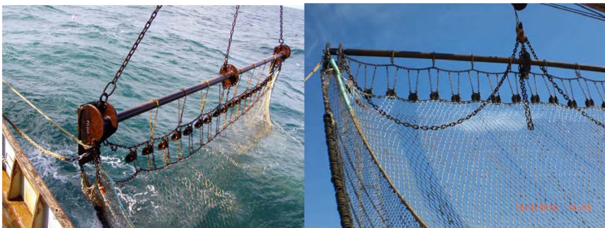
Figuur 3-14: Vijfde ontwerp HydroRig getest in april-mei 2010 (Bron: K.J. Koffeman, schipper FD-281)
