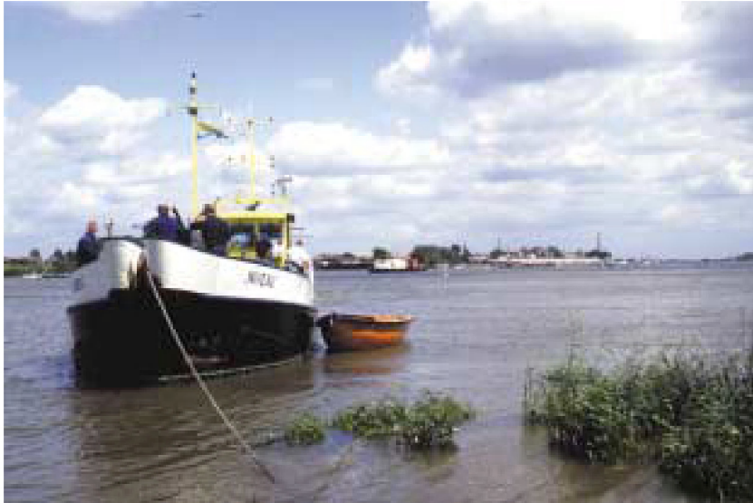
De "Niveau", de kabellegger van Rijkswaterstaat (Meetkundige Dienst) waarmee de antennes van de detectiestations over de bodem van de rivier werden gelegd.
