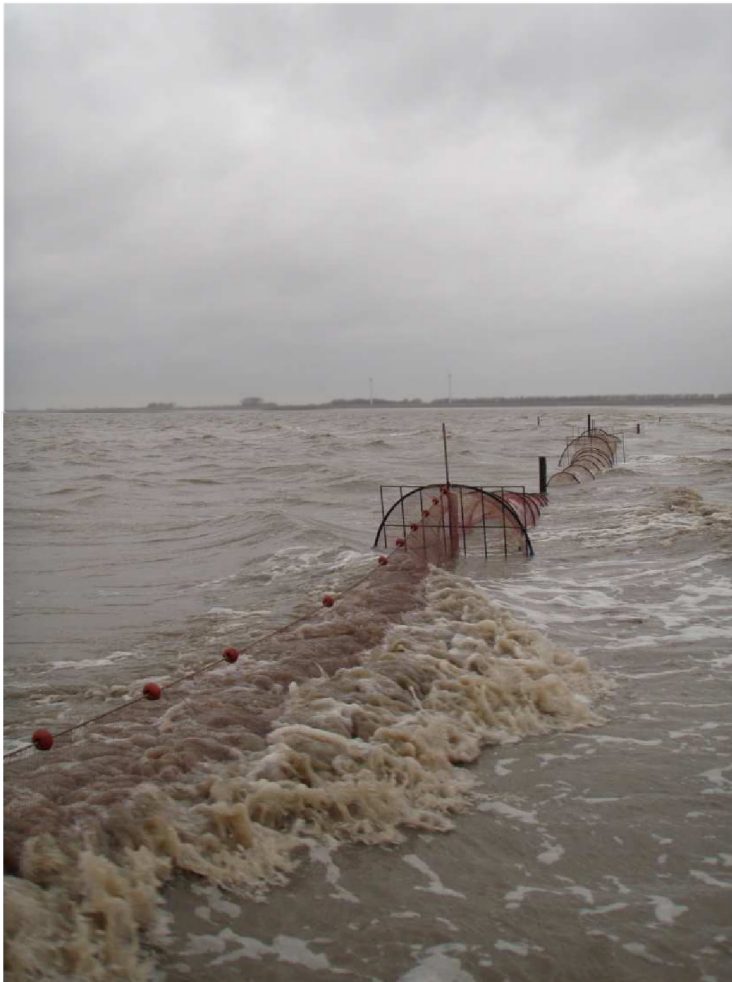
Figuur 5. Dubbele schietfuike in de Zeeschelde nabij Zandvliet met zeehondkeerwand. De netten staan 48 uur op de laagwaterlijn en vangen vis bij hoog water. Om de 24 uur worden de fuien leeg gemaakt. De vissen worden ter plaatse geïdentificeerd, geteld en gemeten. (Foto: Y. Maes, 2011)
