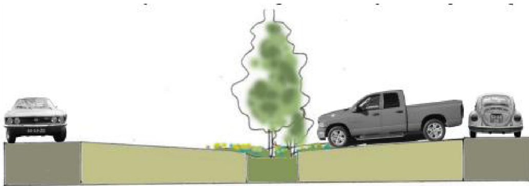
Profiel : parking met wadi en boombeplanting
