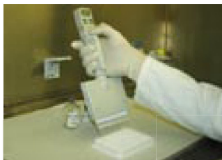
Figuur 2.4: De bioassays ER-CALUX ® , DR-CALUX ® en Mutatox ® worden uitgevoerd in microtiterplaten zoals hierboven weergegeven. Deze plaat bevat 96 kleine vaatjes, 'wells', met een volume van 0,3 ml (foto: RIKZ).
