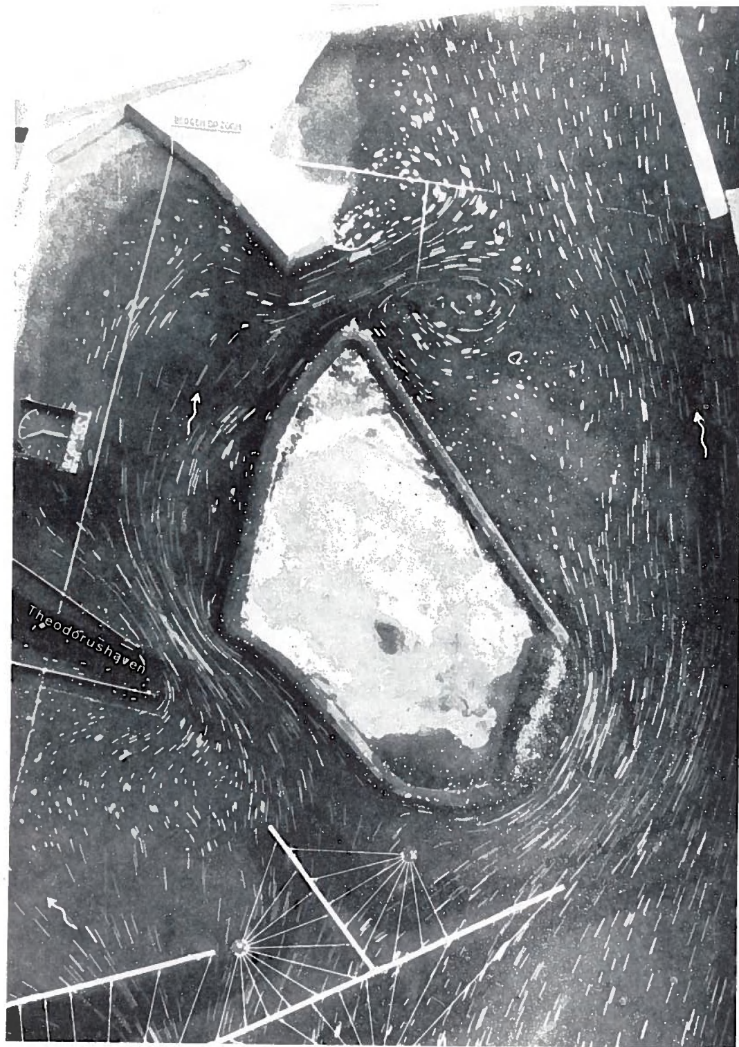
Figuur 106. T35A hoge vloed, 17.00 uur Oppervlaktestroombeld Molenplaat Lengteschaal 1 : 20.000 Snelheidsschaal 1 cm \Delta 1,67 m/s
