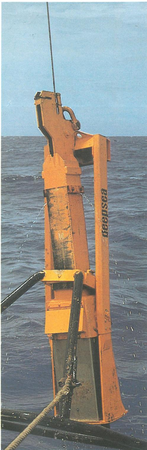
Un carottier est mis à l'eau en vue de prélever des échantillons
