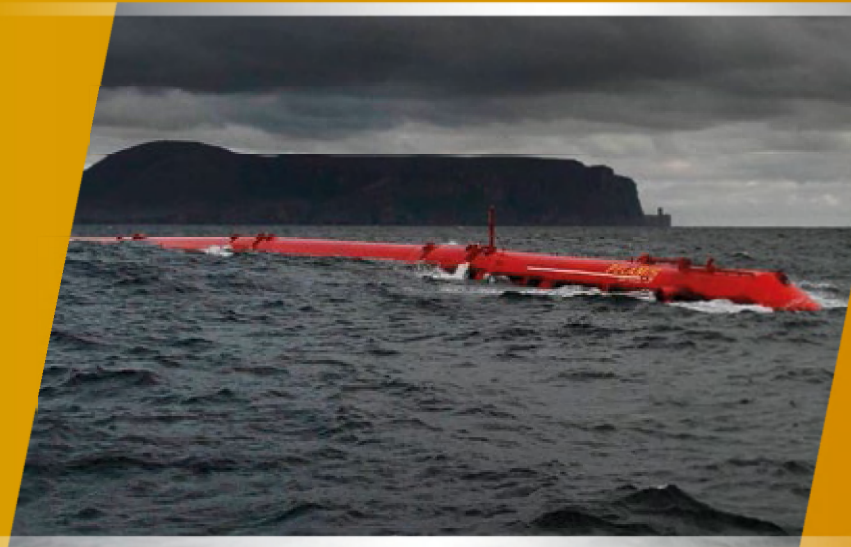
Les convertisseurs d'énergie des vagues (CEV) peuvent aussi être intégrés aux ouvrages de protection. (Crédits Pelamis)
