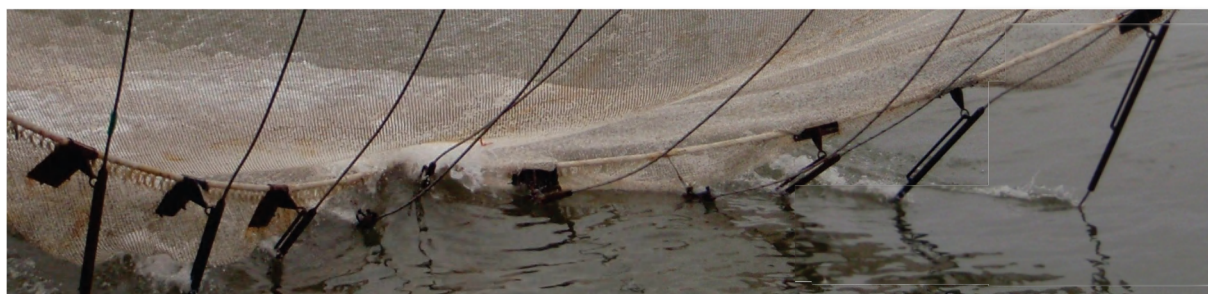
FIGUUR 3-9: AANGEPASTE LANGWERPIGE GEWICHTEN OP DE ELEKTRODEN OM HET NET (ZONDER KLOSSEN) OP DE GEWENSTE HOOGTE VAN DE ZEEBODEM TE HOUDEN.
