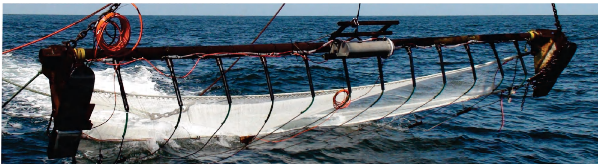
FIGUUR 3-8: CONVENTIONEEL GARNALENNET MET PULS EN ZONDER KLOSSENPEES (CONFIGURATIE 21), MET 12 OP MAAT GEMAAKTE ELEKTRODEN EN 12 CILINDERVORMIGE GEWICHTEN ALS ALTERNATIEF VOOR HET GEWICHT VAN DE KLOSSEN.
