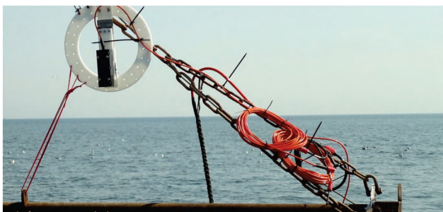
FIGUUR 3-14: ILVO'S REALTIME ONDERWATERCAMERASYSTEEM.
