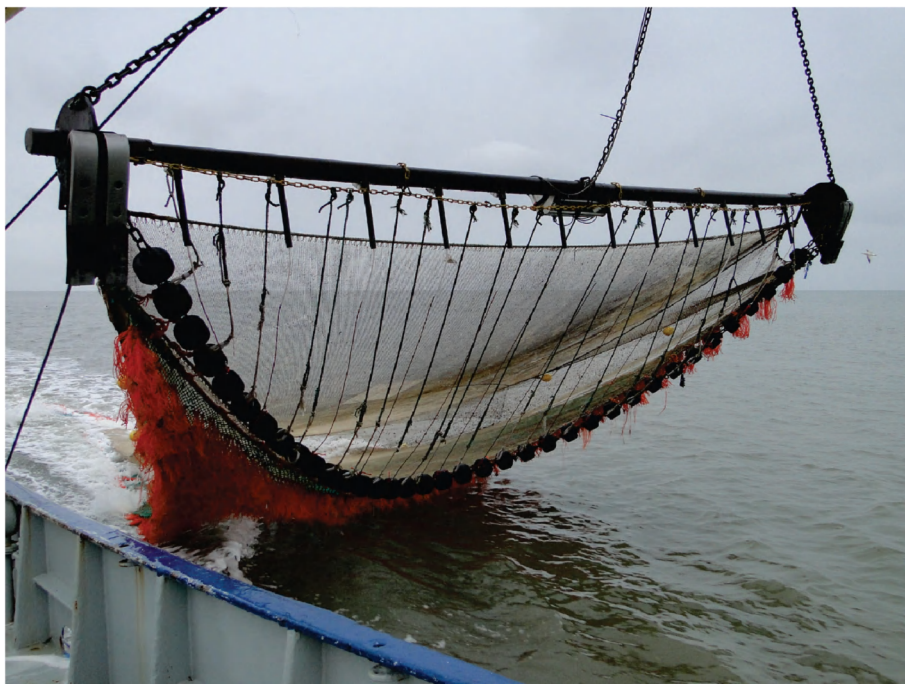
FIGUUR 3-11 – COMBINATIE GARNALENVISTUIG MET KLASSIEK GARNALENNET, KLOSSENPEES MET 36 KLOSSEN EN 12 AANGEPASTE ELEKTRODEN.
