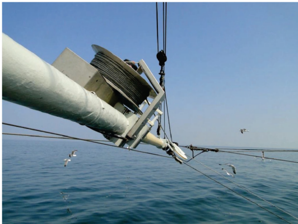
FIGUUR 3-5 - ELEKTRISCHE KABELLIER GEMONTEERD OP DE GIEK (TX 25)
