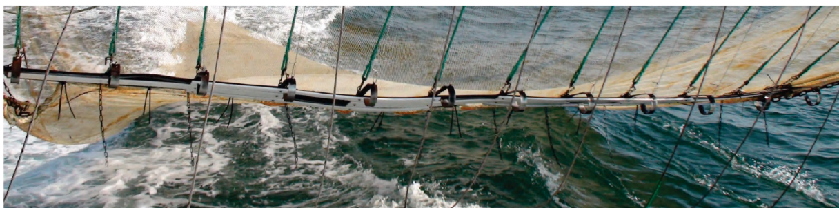
FIGUUR 3-10: VOLDOENDE FLEXIBELE KUNSTSTOFPLAAT BEVESTIGD AAN DE ONDERPEES VAN HET RECHTHOEKIGE NET, MET TREKONTLASTERS EN METALEN TASTERS
