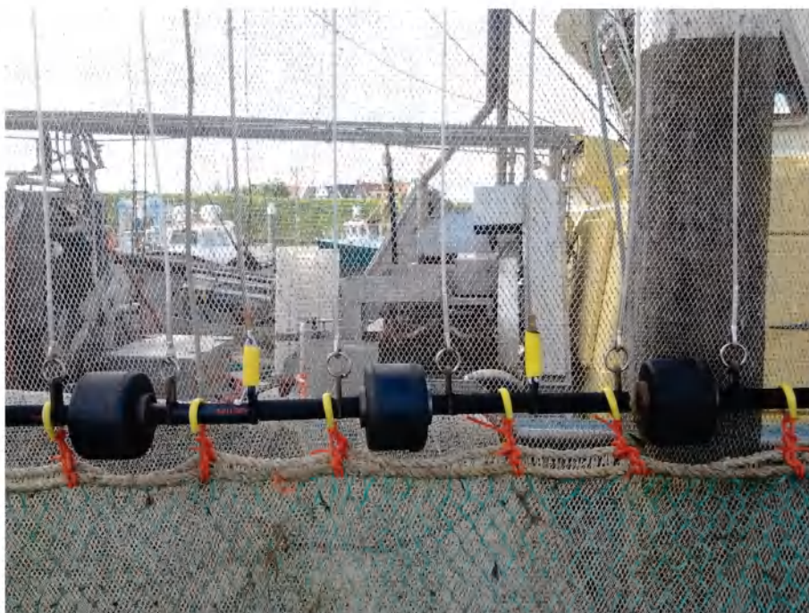
FIGUUR 3-12: AANGEPASTE KLOSSENPEES TX 25; 10 KLOSSEN ALTERNEREN MET DE ELEKTRODEN, DE AFSTAND TUSSEN 2 NABURIGE KLOSSEN BEDRAAGT 70 CM. HET TOTAAL GEWICHT VAN DE KLOSSENPEES BEDRAAGT CA. 100 KG.
