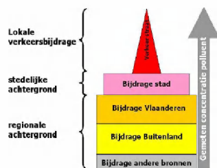
Figuur 13.2: Schematische voorstelling van de opbouw van cocentraties luchtvervuiling in een straat (MIRA-T 2006, bron: IRCEL)
