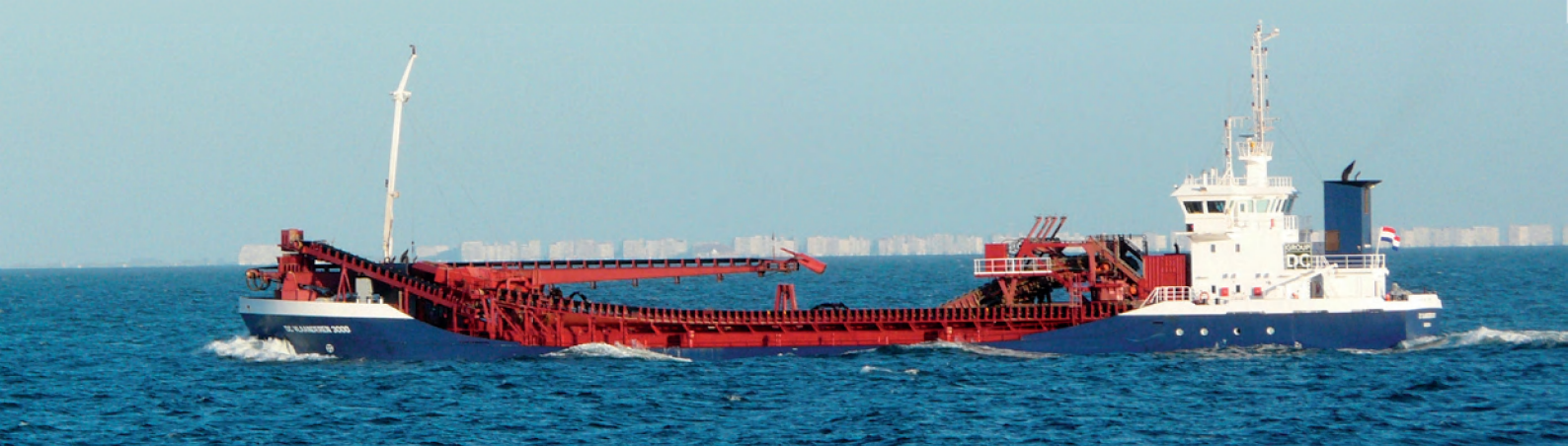
Figuur 12: Ontginningsvaartuig met een laadvermogen van 2.500 m 3 .
