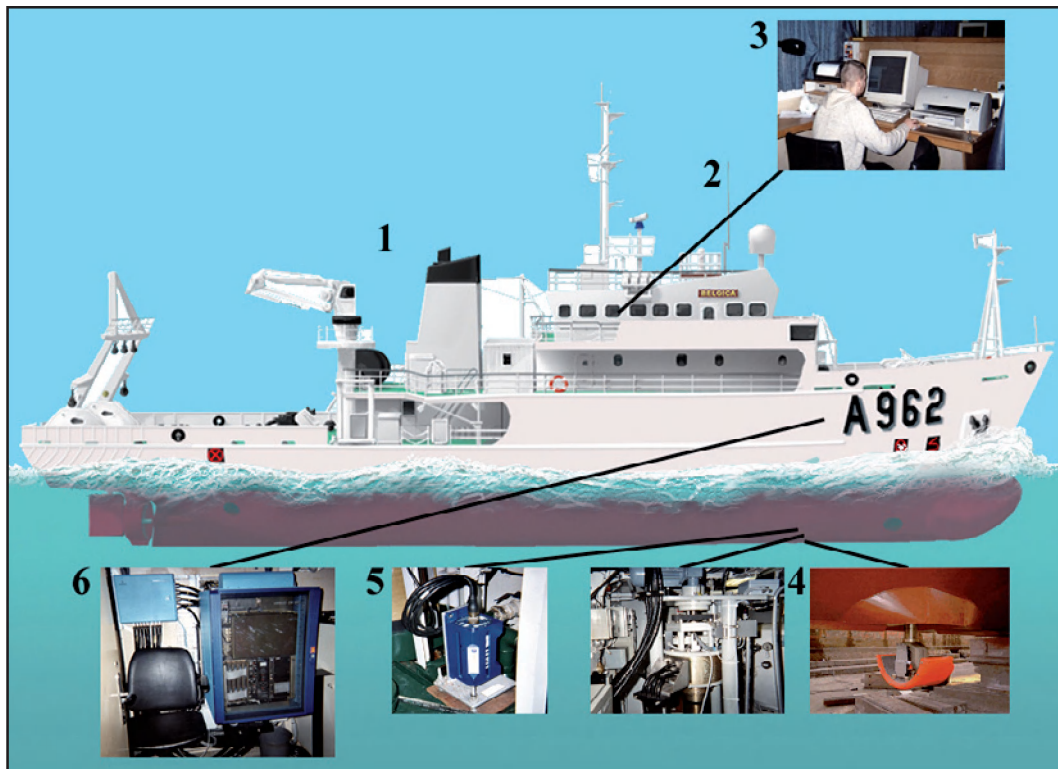
Figuur 5: Multibeam Sonar EM1002S geïnstalleerd aan boord van het onderzoeksschip Belgica en de voornaamste verbonden sensoren. 1: Onderzoeksschip Belgica; 2: GPS antenne; 3: Werkstation van de multibeam sonar op de brug; 4: "Transducer" (sonarantenne) en "hull unit" (buis voor het ophalen en neerlaten van de "transducer"); 5: Bewegingscompensator (meet alle bewegingen van het schip); 6: Zend- en ontvangsteenheid. (Bron: CD-rom "Virtueel bezoek Belgica" KBIN 2004).
