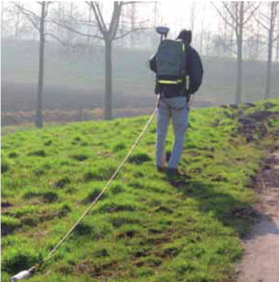
Afbeelding 5.3. Toestellen ingezet bij het niet-destructieve geofysische onderzoek
