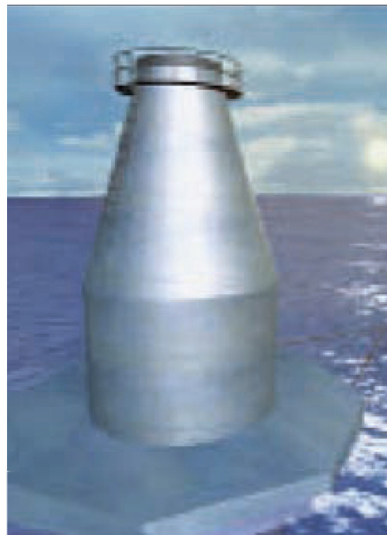
■ De stalen variant van de gravitaire fundering bestaat uit een holle, op te vullen buis en een soort "doos" die de constructie moet wapenen tegen omkantelen. Transport en plaatsing kan een stuk vlotter dan bij de betonnen GBF, maar zeker bij grote waterdieptes blijft de hoge staalprijs een groot nadeel ( http://webarchive.nationalarchives.gov.uk/+http://www.berr.gov.uk/files/file15157.pdf )
