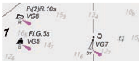
■ Op dit stukje van de kaart zie je drie boeien in de vaargeul naar Zeebrugge. Het symbooltje linksbovenaan toont een rode, laterale, stompe boei met een rood licht. FI(2)R.10s betekent dat deze boei een groepschitterlicht geeft. Het licht knippert twee maal en dan blijft het donker gedurende de resterende 6 seconden. Samen duurt zo'n cyclus dus 10 seconden. Het symbooltje links onderaan is een groene, spitse laterale boei. FI.G.5s betekent dat deze boei een groen schitterlicht geeft dat eens om de 5 seconden knippert. Deze boei dient dus aan stuurboordzijde gepasseerd te worden om de juiste vaarroute te bevaaren. Het symbooltje rechts staat voor een meerkleurige, zwart-geel horizontaal gestreepte kardinale boei (VH)
