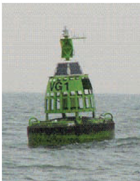
■ Een laterale boei geeft aan waar het vaarwater zich bevindt. Rode, stompe boeien dienen steeds aan bakboordzijde te worden gepasseerd, groene spitse boeien aan stuurboordzijde (VH)
