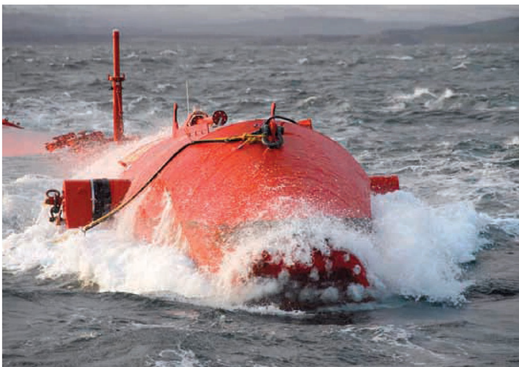
■ Pelamis: prototype 750 kW (Pelamis Wave Power)
