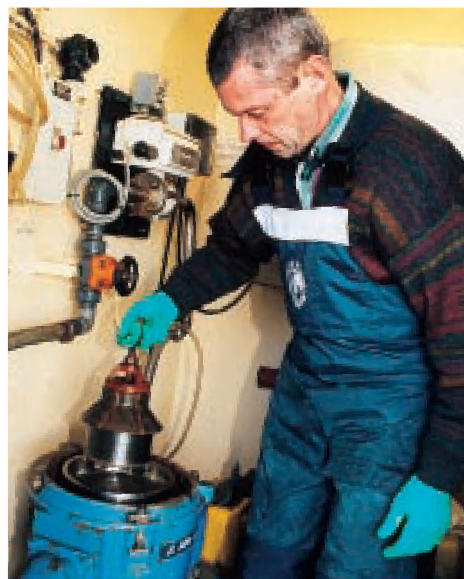
Aan boord van de Belgica wordt particulier materiaal van het zeewater gescheiden door middel van een doorstroomcentrifuge (ANCH)
