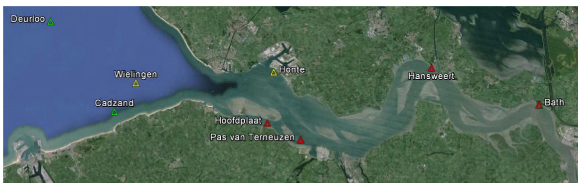
Figuur 2.7 Ligging van de meetstations (directional waverider = groen, boei = geel, golfbaak = rood) van golven in de Westerschelde en in de monding.
