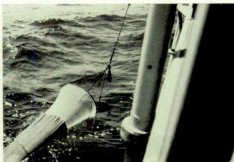
FIG. 2. — Le filet pélagique attaché au tangon.
