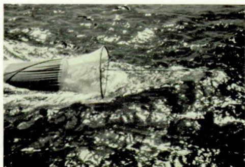
FIG. 2. — Le filet pélagique attaché au tangon.
