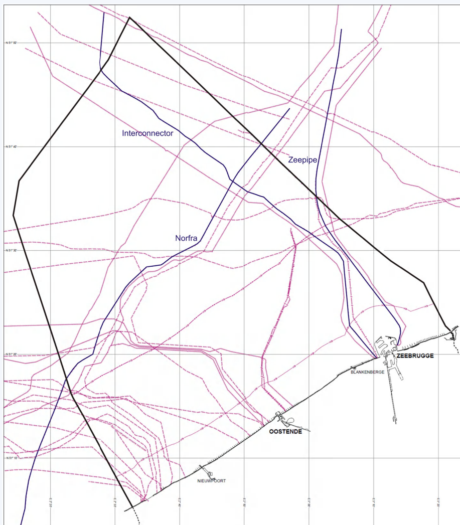
Figuur 5. De kabels (paars) en pijpleidingen (donkerblauw) in het BNZ ( Continental Plat & Vlaamse Hydrografie 2013 )
