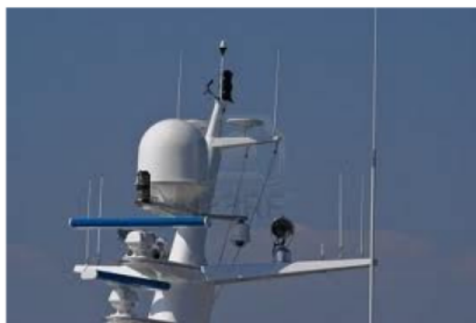
Figuur 47. Voorbeeld van de montage van de antennes van een scheepsradar op de masten
