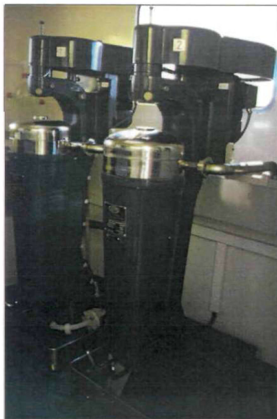
Figuur 5. Parallele centrifugeopstelling in meetcontainer (Meet- en Informatiedienst IJsselmeergebied)
