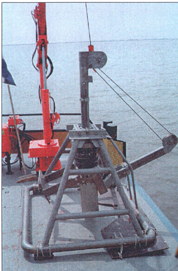
Figuur 8. Boxcorer voor monsterneming van waterbodem
