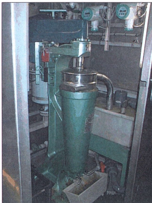
Figuur 12. Doorstroomcentrifuge in meetcontainer Meetinformatiedienst Zeeland
