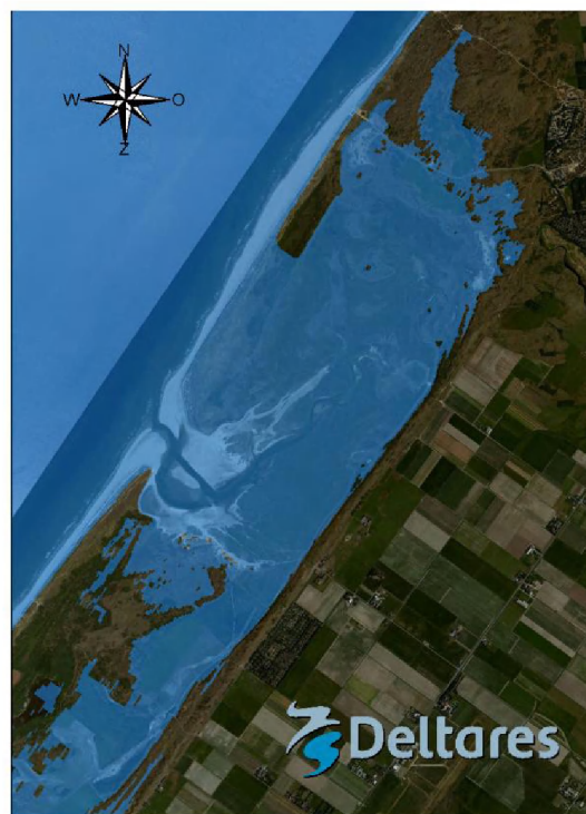
Figuur B.4 Maximale inundatie Slufter als gevolg van een 1/4000 per jaar storm (geen duinen voor de Slufter, NW golven).
