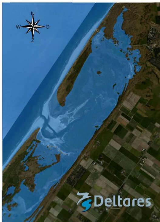
Figuur B.2 Maximale inundatie Slufter als gevolg van een 1/4000 per jaar storm (brede Sluftermonding, NW golven).
