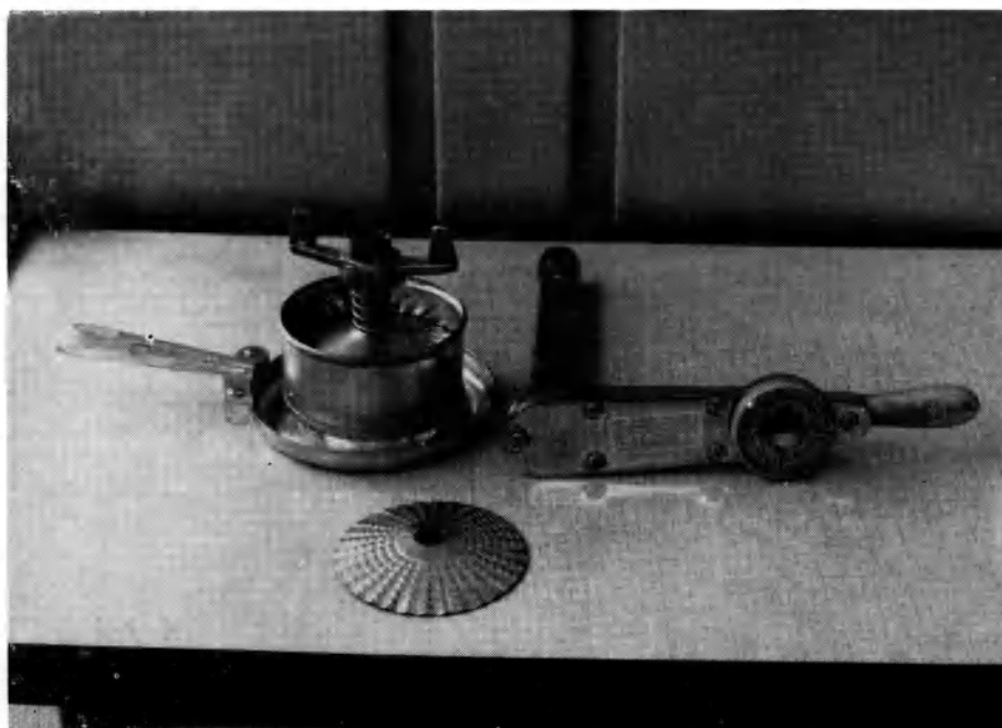
Fig. 1. — Handpers voor de bereiding van vissap (rechts : momentsleutel)
