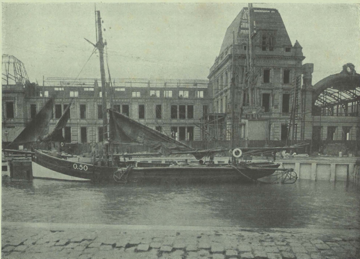
FIG. 1. — « L'Avenir », chaloupe modèle armée d'un chalut à fers déclinants. — Moteur à pétrole de 60 chevaux. — Hauteur des fers : 1 m 10. — Poids de chaque fer : 120 k. — Longueur de la gaule : 17 m. Armateurs M.M. L Janssens et Mestdagh, Ostende, Patron : Pierre Neut.
