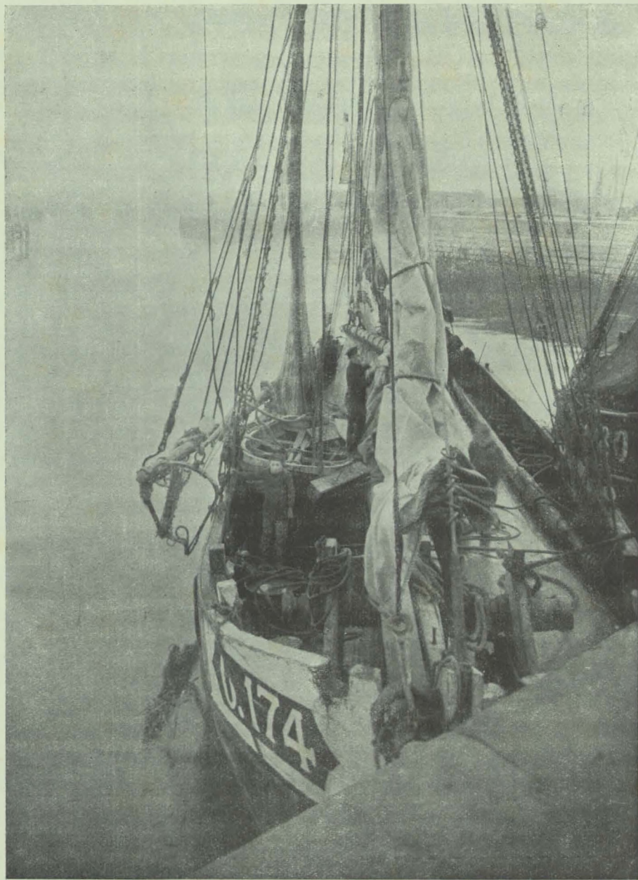
FIG. 4. — Chaloupe d'Ostende. Saillie du fer sur le flanc du navire. Position oblique de la gaule, comme à la levée du chalut. Noter, à l'angle inférieur, l'œillet destiné à l'attache du bourrelet. Il est inutilisé ici, car le bourrelet n'y passe pas.
