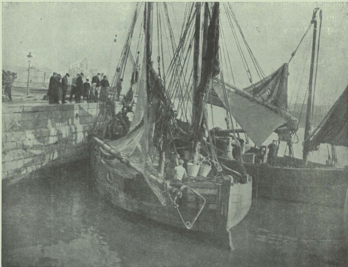
FIG. 6. — Chaloupe d'Ostende. Position du chalut à la rentrée dans le port : un des fers est visible à l'arrière ; l'autre est pris à bord devant les haubans, sur lesquels s'appuie le bout avant de la gaule. Œillet d'attache à l'angle inférieur et postérieur, inutilisé, car le bourrelet se voit plus haut fixé par une manille qui peut glisser sur toute la colonne d'arrière.
