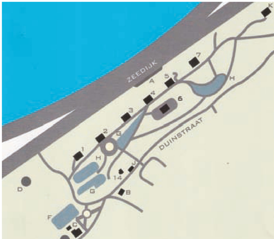
■ Die Batterie Aachen (Provinciedomein Raversijde) enthält u. a. alle typischen Bestandteile einer Batterie: 1: linker Beobachtungsbunker, 2, 3, 4, 5: Geschützstellungen, 6: bombensicherer Schutzraum, 7: rechter Beobachtungsbunker, 14: Barbara Brunnen, A: Königliches Chalet, B: Norwegisches Haus, C: Haus des Leuchtturmwärters, D: niedriges Leuchtfeuer, E: hohes Leuchtfeuer, F: Offiziersunterkunft, G: Mannschaftsunterkünfte, H: zentrale Munitionsdepots, J: Wachstube, K: Beobachtungsposten zwischen der Batterie Aachen und der Batterie Antwerpen (Provinz Westflandern-Raversijde)
