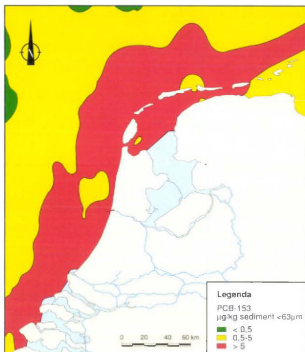
Figuur 6 PCB-153 gehalten in het sediment van de zoute wateren. Toenemende gehalten in de richting van de kust en in de estuaria geven aan dat het stroomgebied van Rijn, Maas en Scheide een belangrijke bron van PCB's is. Bron: hoofdstuk 4A, 4B en 4C
