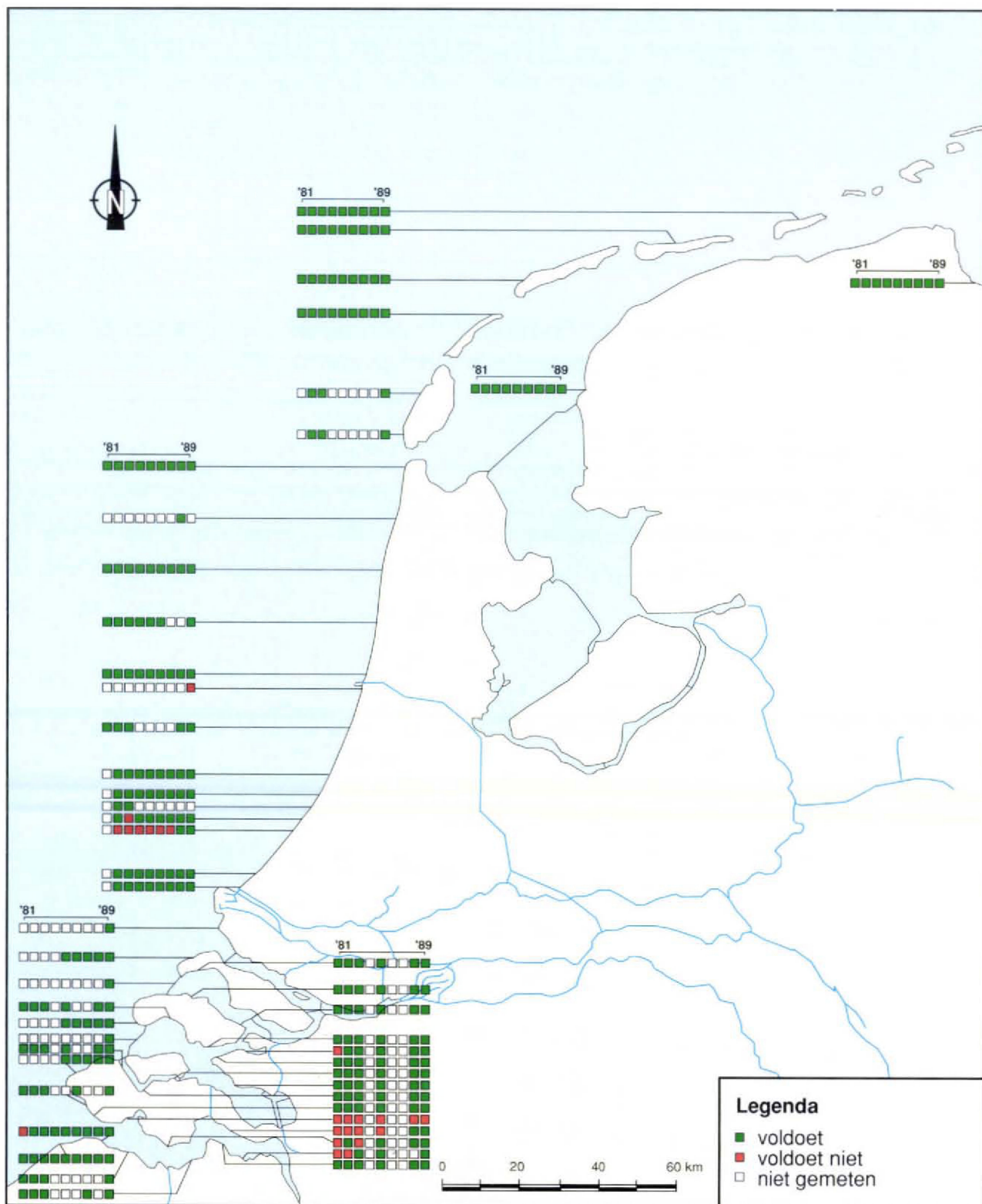
Figuur 3 Ontwikkeling van de Zwemwaterkwaliteit volgens E.G.-normen (periode 1980-1990). De bacteriologische kwaliteit is verbeterd door het aanleggen van rioolwaterzuiveringsinstallaties. Bron: hoofdstuk 4A, 4B en 4C
