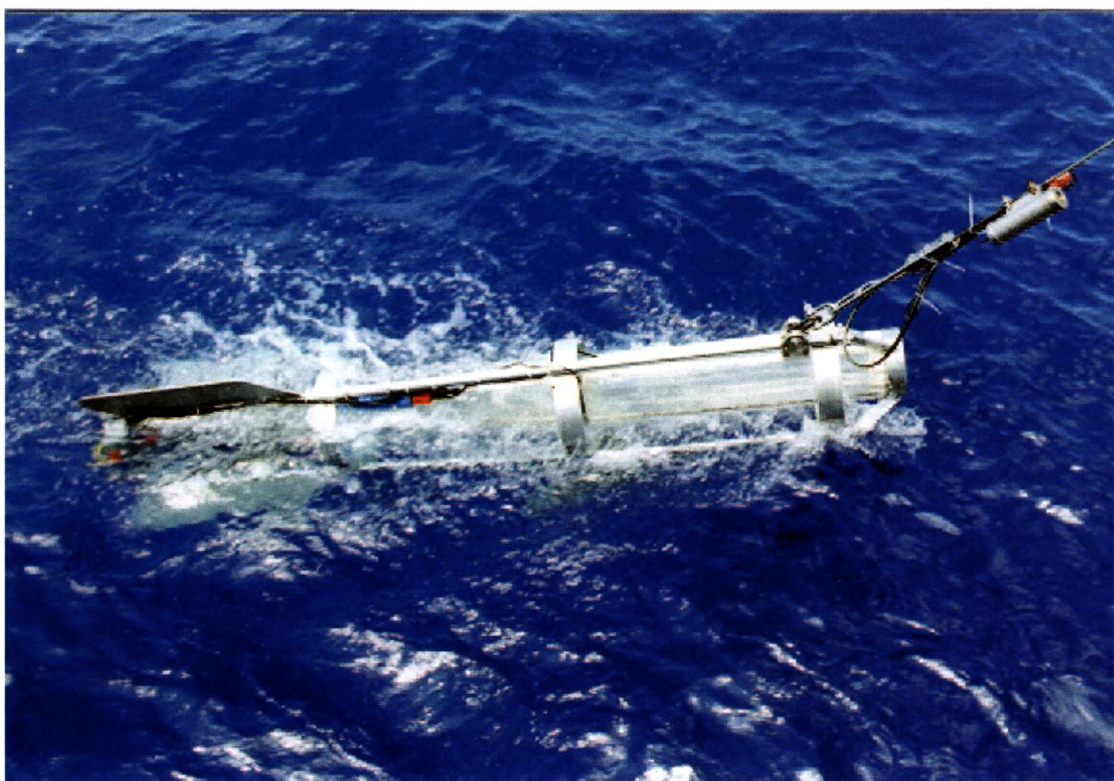
Figure 8. Ichthyoplankton recorder from the Institut für Meereskunde University of Kiel Germany, courtesy Norbert Rohlf.
