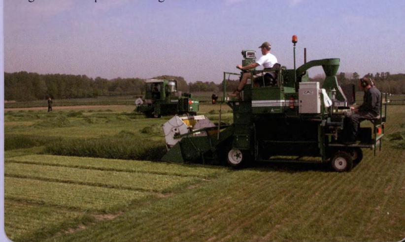
Opbrengst en kwaliteitsbepaling met groenvoederproefveldoogstmachine
