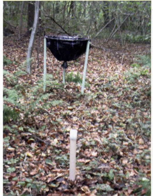
In 20 natte bosproefvlakken werden nabij de waterstandsbuizen bladvalnetten geplaatst om de jaarlijkse bodemaanrijking door organische stof en nutriënten te bepalen.
