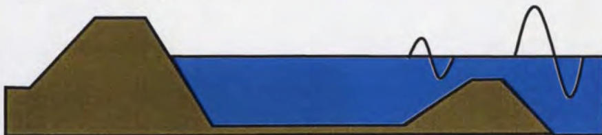
Figuur 16: schematische weergave van een golfremmende constructie
