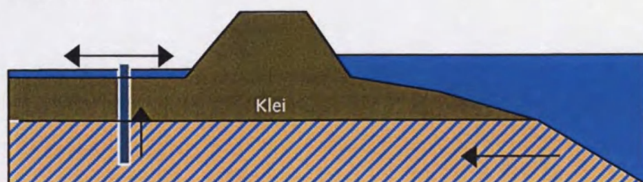
Figuur 12: schematische weergave werking kwelbuizen
