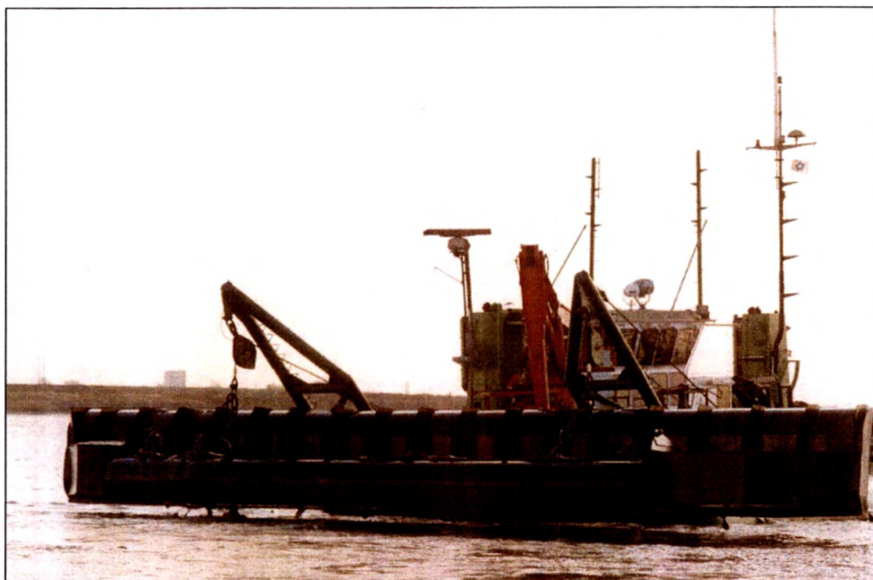
Figuur 2-2 : Ploeg of Sweepbeam
