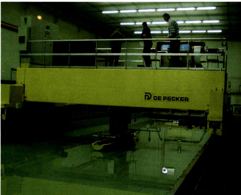
Figuur: de sleeptank voor krachtenonderzoek op schepen
