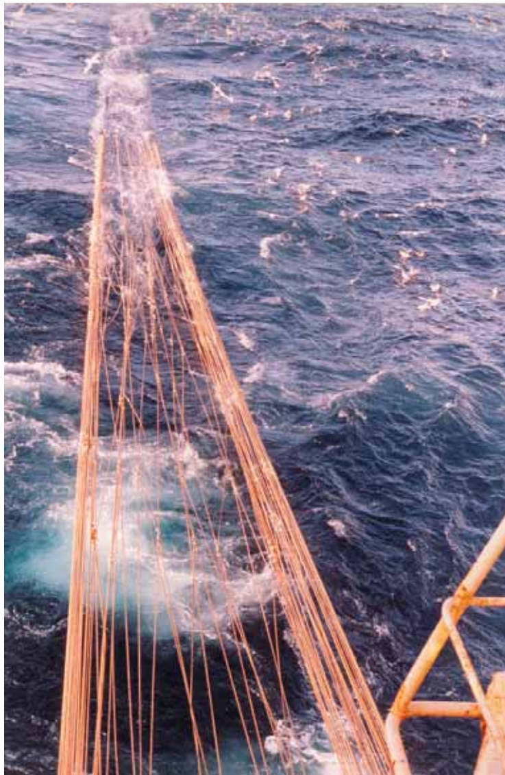
Figura 9. Vista de las mallas de 6,40 m, utilizadas por la red pelágica, en el momento de lanzar la red para pescar.
