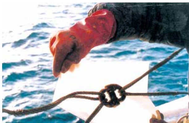
Empalme de las mallas de acero en grillete trawlex (red pelágica).
