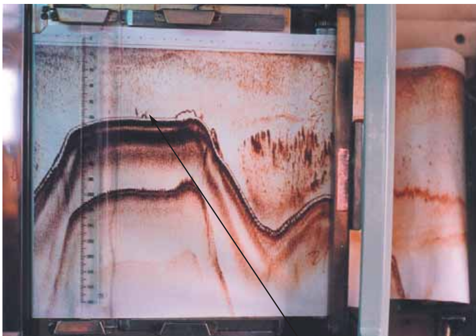
Ecosonda del buque, frecuencia 200 khz
