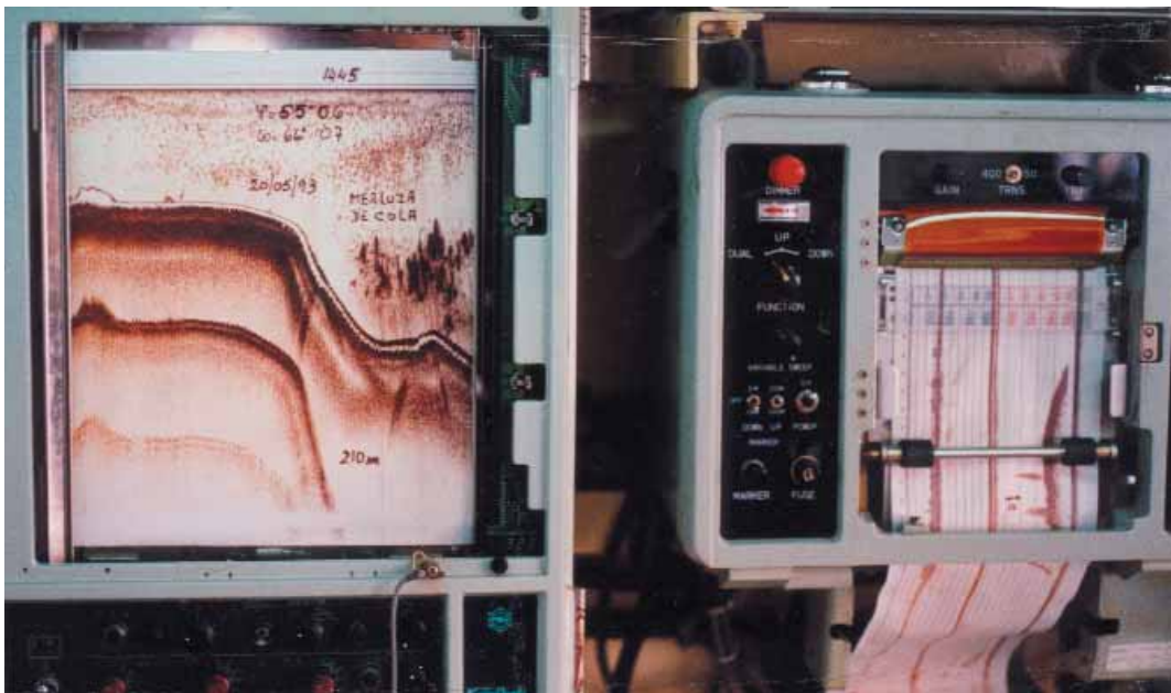
Ecosonda del buque (24 khz). Cardumen en el fondo
