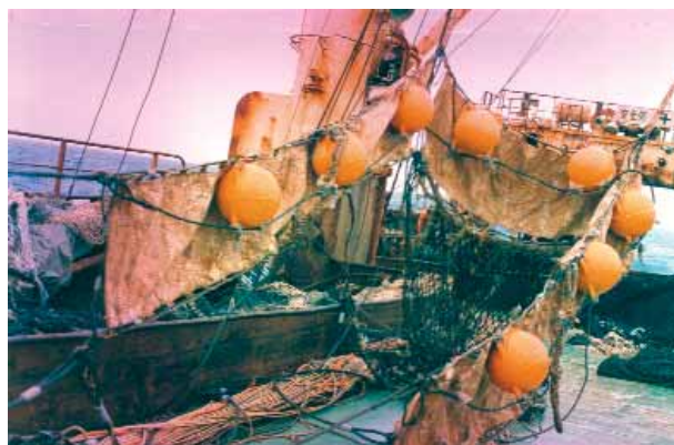
Vista del kite o barrilete de dracón montado en la relinga superior.
