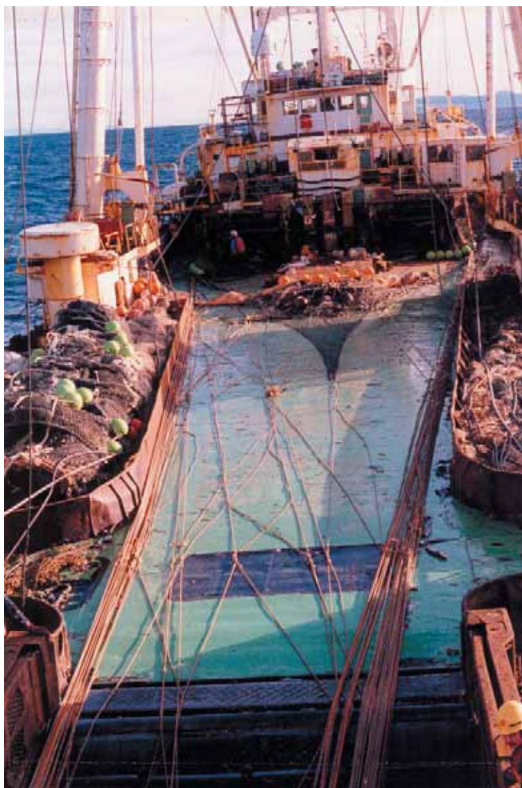
Figura 8. Vista de las mallas de 20 m, utilizadas por la red pelágica, en el momento de lanzar la red para pescar.
