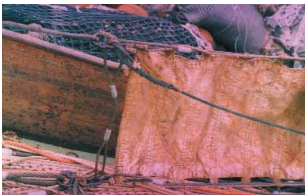
Vista del montaje del kite o barrilete en la relinga superior.
