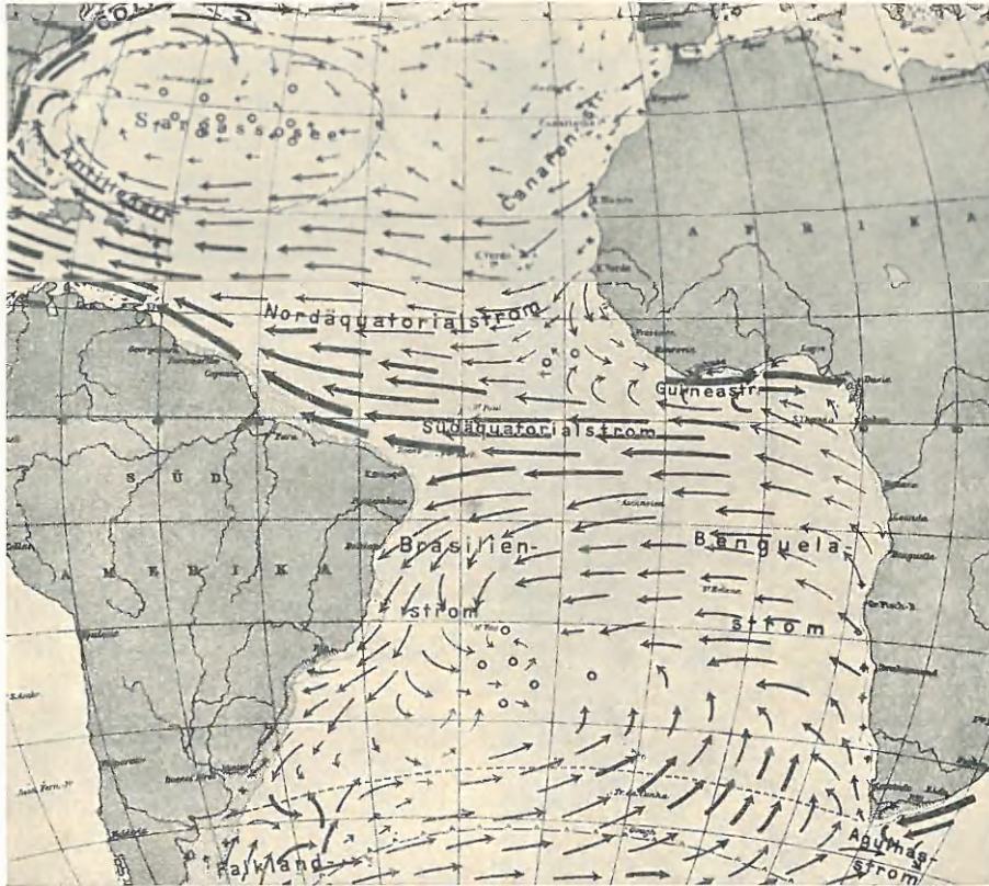
Textfig. 3. Oberflächenströmungen im südlichen Atlantischen Ozean. (Aus SCHOTT: Geographie des Atlantischen Ozeans.) Die Dicke der Pfeile gibt die Stromgeschwindigkeit, die Länge die Strombeständigkeit an.
