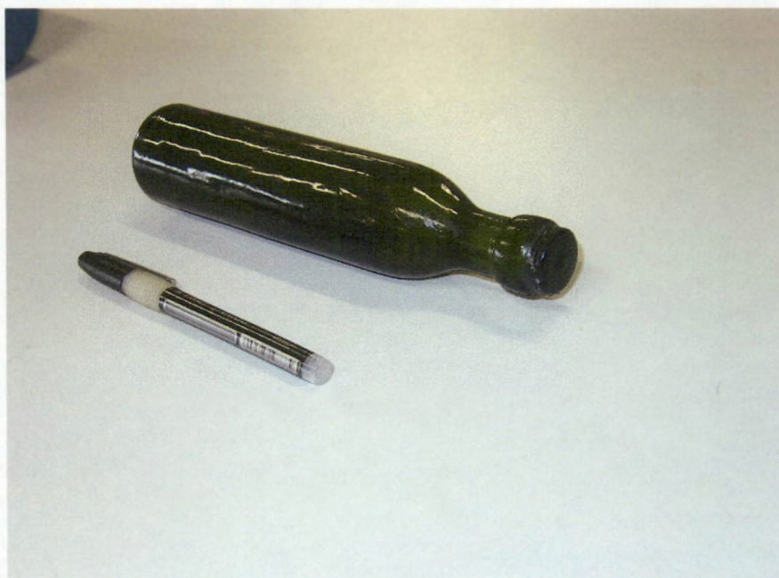
Figuur 1.3: Glazen flesje waarin Clark I of II werd gestockeerd in de obus. Het flesje werd afgesloten door een stop en een zegel. Door het verouderingsproces kan de stop beginnen lekken en dringt de chemische stof door tot in de springstofmantel.
