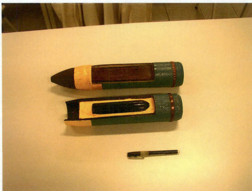
Figuur 1.2: Dwarsdoorsneden van 77 mm obussen met chemische lading. Bovenaan is een typische obus met Ypriet of (di)fosgeen lading. Onderaan is een Clark obus met binnenin het glazen flesje en de lading springstof errond te zien.
