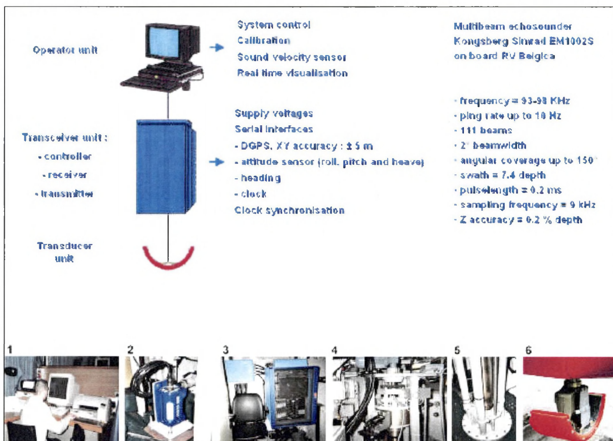
Figure 22 : Le sondeur multifaisceaux Kongsberg-Simrad EM1002S installé à bord du navire de recherche Belgica ; 1 : station de l'opérateur ; 2 : Seatex MRU5, senseur de mouvement du navire ; 3 : unité de contrôle, de transmission et de réception ; 4 et 5 : système mécanique de remontée du « transducteur » dans le sas ; 6 : le « transducteur ».
