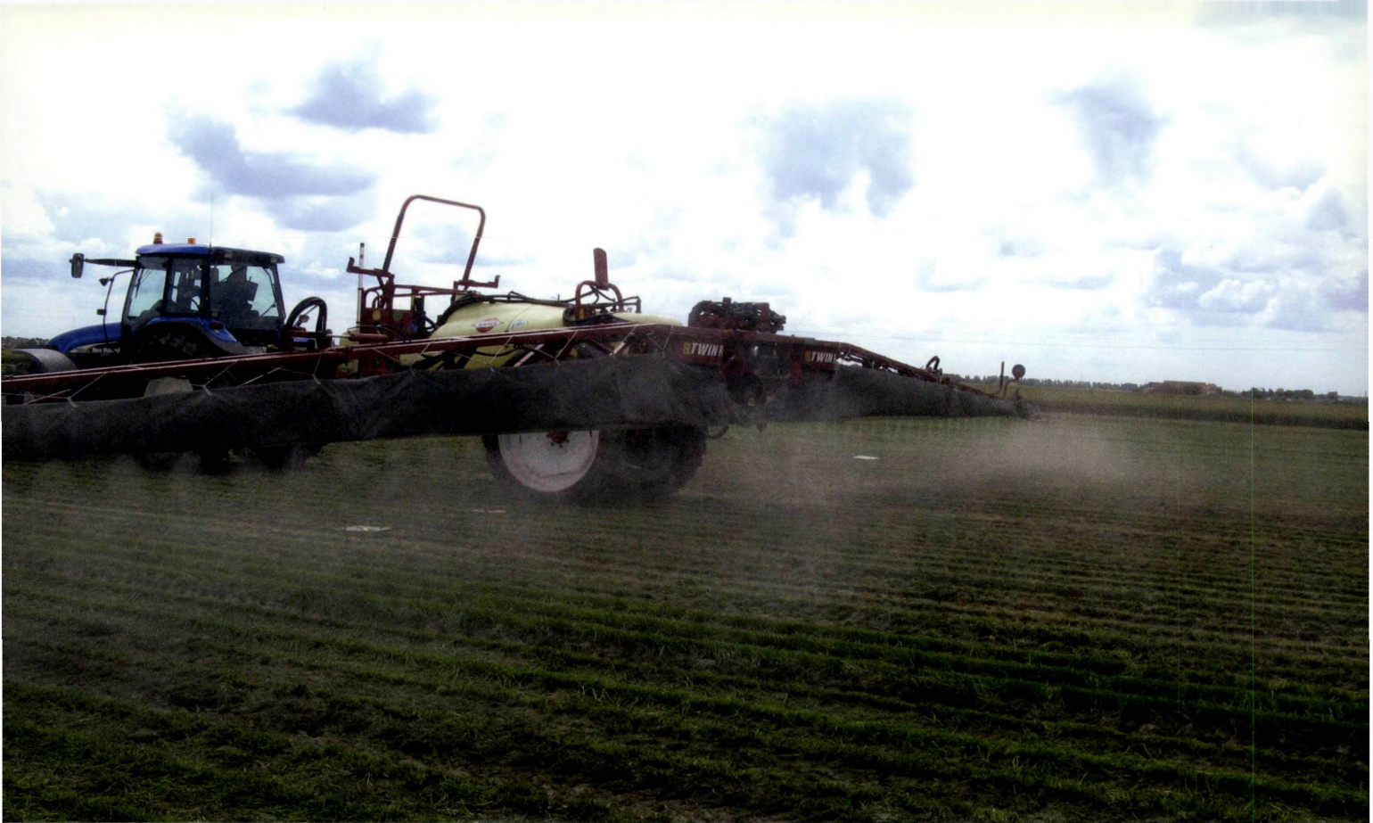
Afhankelijk van het doptype, zorgt een spuittoestel met luchtondersteuning voor een driftreductie van 75 tot 90 procent ten opzichte van de klassieke spuittechniek.
