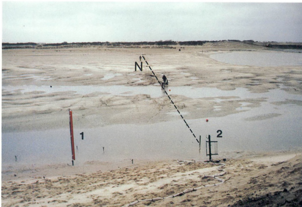
Foto 3.A. Meetcampagne 19 maart 1991. Lokatie Noord (mondingsgebied van de Zvingeul). 1 : tijbaak; 2 : staketsel Noord; N : raai Noord. Boeien markeren de meetvertikalen. Meertje op de achtergrond, rechts : de noordelijke zandvang. De foto is genomen bij laagwater van op de westelijke oever.
