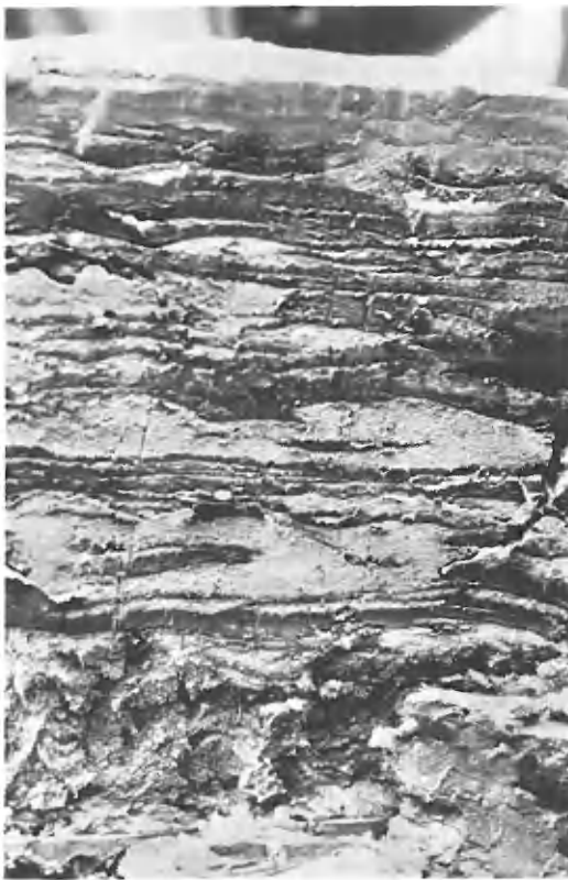
1. Sedimente aus dem Jadebusen, mit dem Kastengreifer nach REINECK entnommen. – Typische Schichtung eines Gezeitenmeeres mit Wechsel von grob- und feinkörnigen Sedimenten. Die besonders mit Schwermetallen belastete Fraktion <20\ \mu\text{m} ist in den feinkörnigen Lagen mit einem Anteil von etwa 50 % beteiligt, während ihr Anteil in den Sandlagen unter 1 % sinkt.
