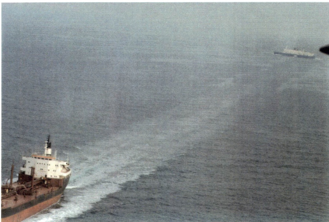
Figuur 12. Kielzog van een schip juist na het doorvaren van een uitgestrekte olielaag.
