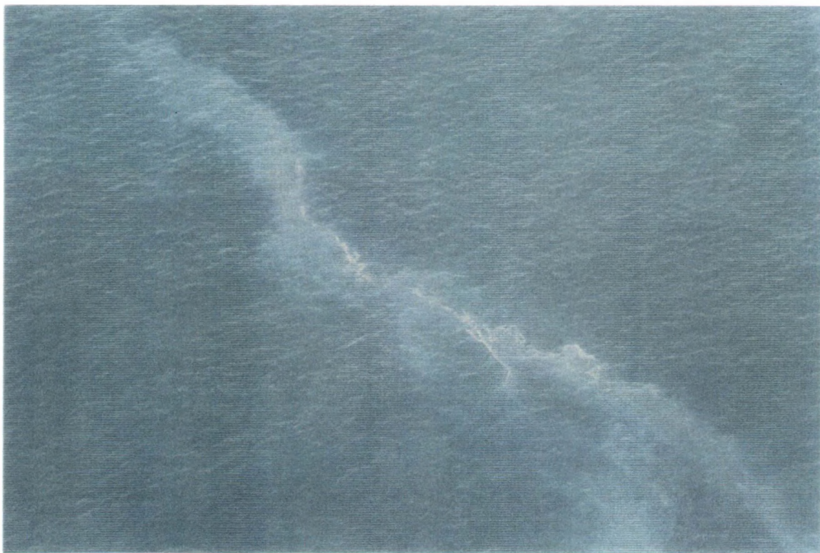
Figuur 11. Illegale lozing waarschijnlijk afkomstig van lensvlakwater behandeld met detergenten vóór het overboord pompen.
