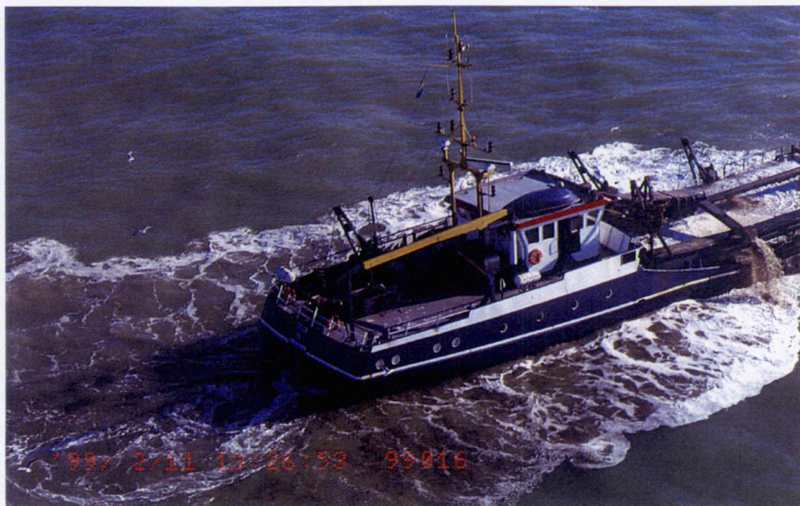
Foto 7. Een zand- en grindwinningschip in actie.
