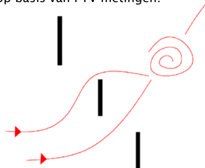
Fig. 8. Ontstaan van turbulentie door de aanwezigheid van dammen.
