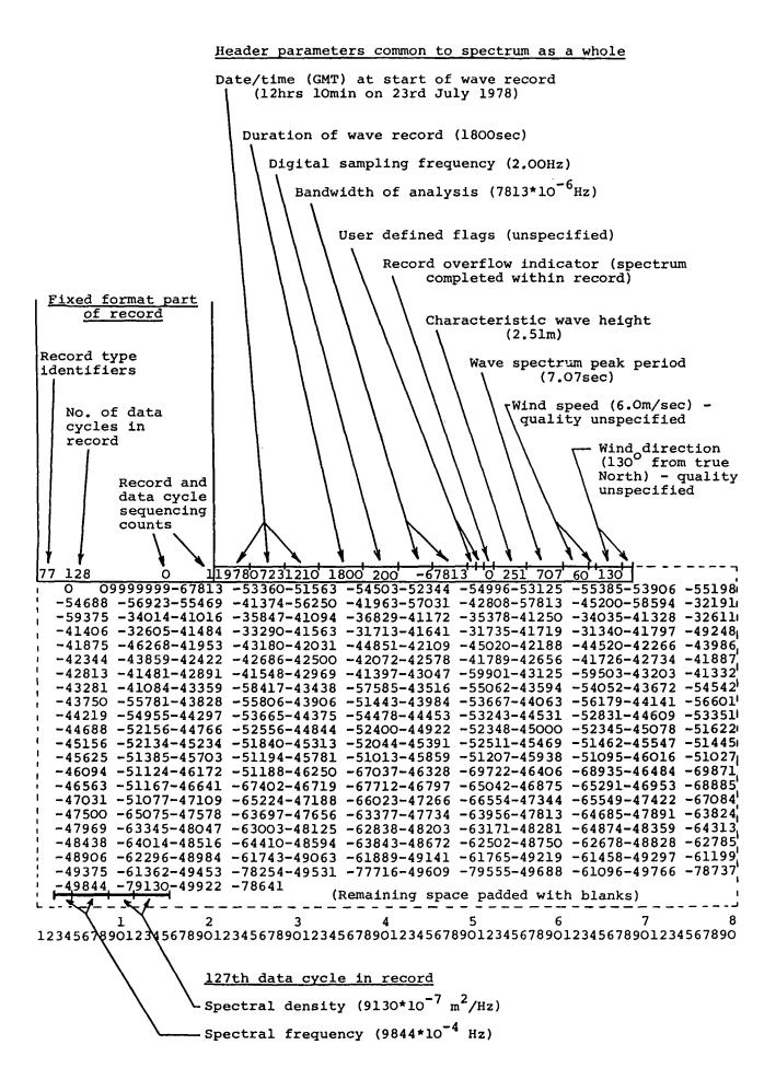
STANDARD GF3 SUBSET FOR DIGITAL WAVE RECORDS
