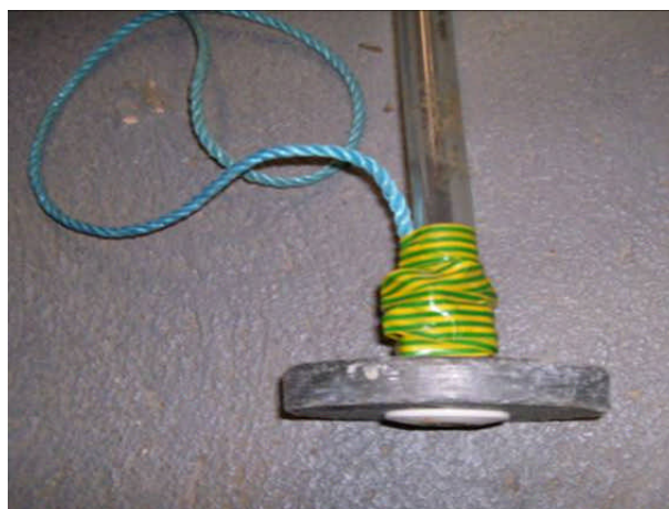
Fig. 3. Plomo con forma de disco que rodea el extremo inferior de la manguera de muestreo (Foto R. Raine).
