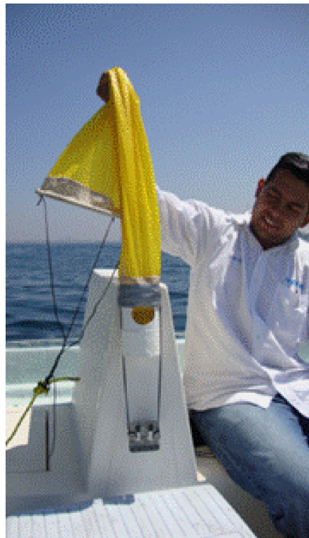
Fig. 1. Izda. Red de plancton con colector con llave acoplada para la descarga de la muestra. Dcha. Red de plancton con colector o copo y peso acoplado para el descenso en el agua (modelo suministrado a los participantes en el proyecto RLA/7/014).
