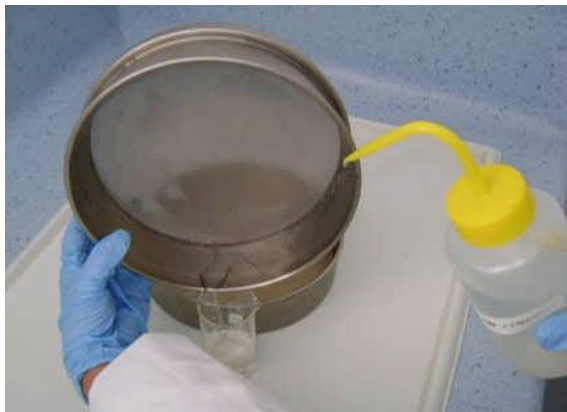
Verter la muestra en un frasco de 50-100 ml apropiadamente etiquetado y sellado para su almacenamiento
