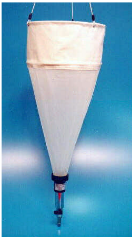
Fig. 1. Izda. Red de plancton con colector con llave acoplada para la descarga de la muestra. Dcha. Red de plancton con colector o copo y peso acoplado para el descenso en el agua (modelo suministrado a los participantes en el proyecto RLA/7/014).
