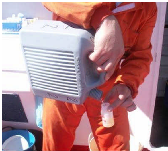
Toma de una alícuota, para análisis cuantitativo de fitoplancton u otros análisis, en frasco debidamente etiquetado (fecha, estación, rango de profundidad).
