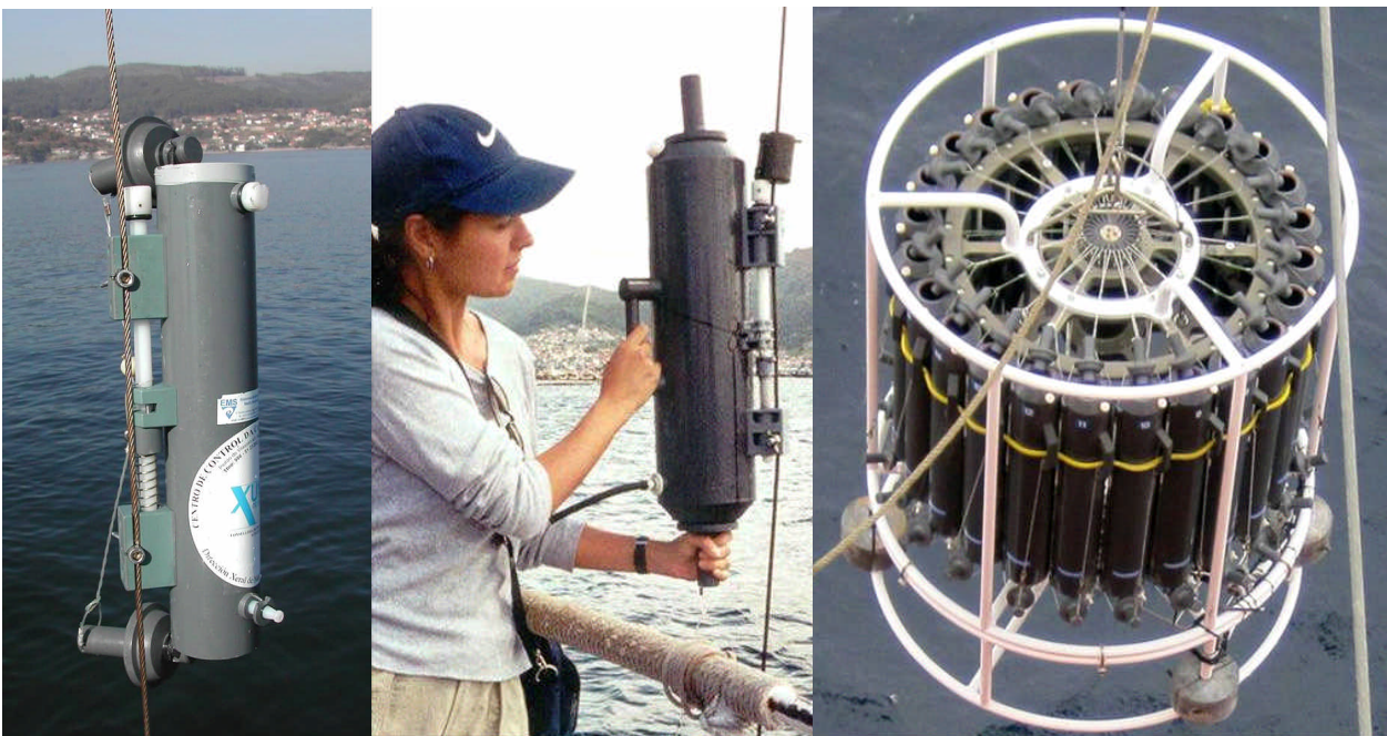
Fig. 1. Izda., botella oceanográfica «armada» antes de ser lanzada, con las tapas abiertas. b) Centro, botella recuperada tras lanzar el mensajero e izarla. c) Dcha., roseta con 24 botellas oceanográficas.
