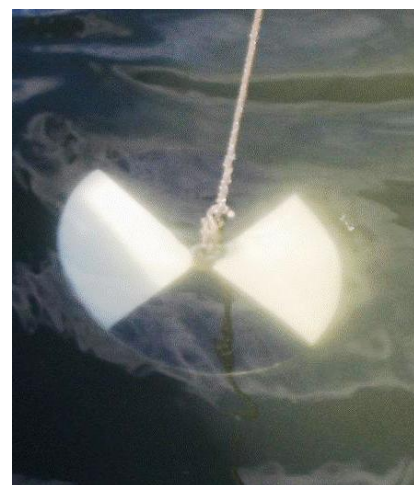
Fig. 1. Distintos modelos y partes de un disco de Secchi y aspecto de un disco sumergido en aguas con abundantes pigmentos verdes.
