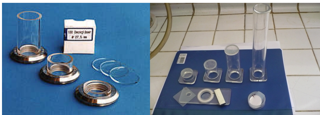
Fig. 1. Izda., cámaras de sedimentación simples de 25, 10 y 5 mL; dcha. cámaras de sedimentación compuestas: columnas de 10, 25, 50 y 100 mL y placa de sedimentación con el cubre cuadrado (izda.) y llave (dcha.) para desenroscar el anillo metálico.
