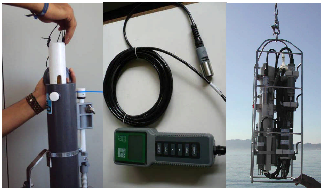
Fig. 1. Izda., uso de termómetro de inmersión introduciéndolo directamente en la botella oceanográfica; Centro, sonda multiparamétrica YSI para medir temperatura y salinidad; Dcha. Sonda multiparamétrica CTD (Conductivity, Temperature, Depth) colgada del torno del barco antes de ser lanzada.
