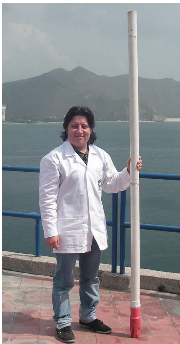
Fig. 5. Tubo muestreador ( \geq 2 m), con válvula de retención del agua en el extremo inferior, utilizada por INVEMAR (Colombia).
