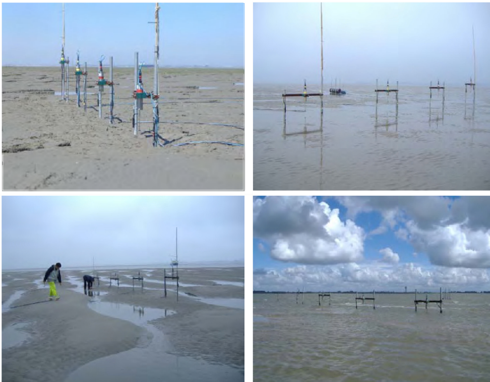
Figuur 8. Opstelling voor de hydrodynamische metingen op het centrale deel van de plaat (linksboven), rand van de plaat (rechtsboven) en noordelijke landtong (linksonder) in juni 2006. De foto rechtsonder toont een meetopstelling tijdens inkomend tij in augustus 2006.
