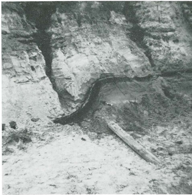
Photo 1 : The peatlayer C is cut off by river sands and is bent down. Veenlaag C wordt door rivierzanden afgesneden en is bovendien naar onderen geplooid
